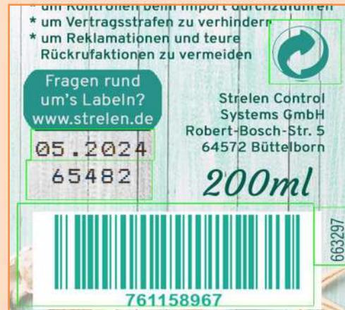
*Nach dem Auflegen einer Verpackung wie einer Lebensmittel- oder Pharmaverpackung oder eines Kosmetikprodukts (hier als Beispiel Babyöl) detektiert die Software die zuvor festgelegten Prüfdaten.*
